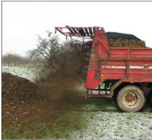
Abb. 16. Mischung der Kohle erfolgt per Streumechanismus.
