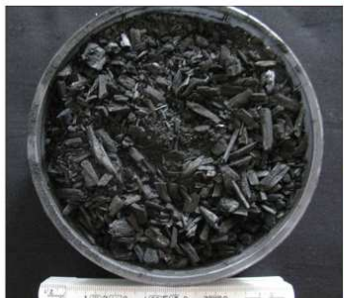
Abb. 13. Kohlepartikel nach Verkohlung in der BiGchar-unit (im Carbo-Mob integriert)
