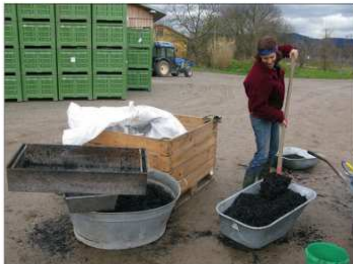
Abb. 10 und 11. Kohleernte: wichtig ist vollständiges Ablöschen. Die Kohle kann bis zur Verwendung offen und nass gelagert werden.
