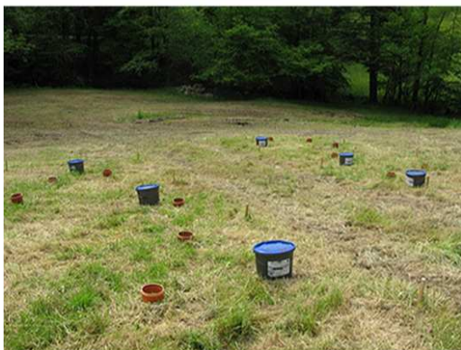
Bild 24: Verteilung der Messkammern auf der Versuchsfläche
