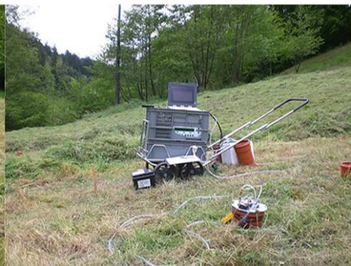
Bild 25: Vielfachgasmonitor für Feldmessungen präpariert
