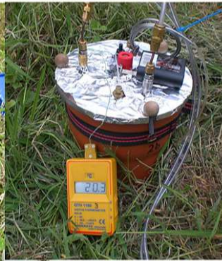
Bild 21: Messdeckel mit Verbindung zum Gasmonitor
