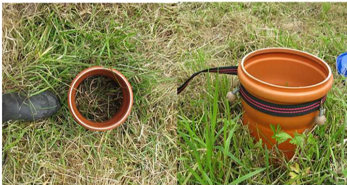
Bilder 18 - 20: Plastikzylinder, die 15 cm tief in den Boden eingeschlagen wurden, dienen als Messkammer
