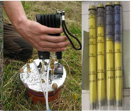
Bilder 22/23: Messung von NH 3 mit Dräger-Röhrchen
